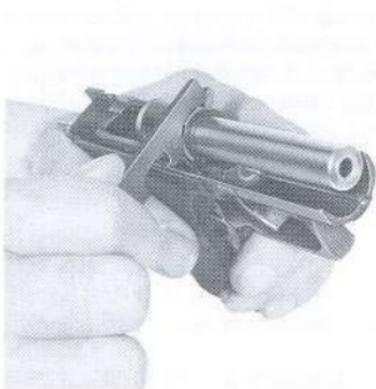
Bild 11: Rohr entnehmen
